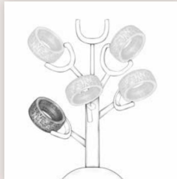
Das Schmuckstück wird in Wachs gedruckt und nach der Qualitätsprüfung auf einen Gussbaum aufgesetzt.
