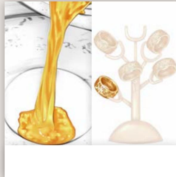
Unter Vakuum wird nun das flüssige Edelmetall in die Küvette eingegossen. Nach dem Abkühlen wird der Gips entfernt.
