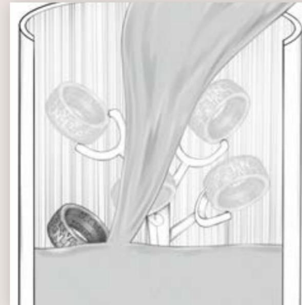
Der Gussbaum wird in einer Küvette platziert und diese mit Gips befüllt. Es entsteht eine Negativform.
